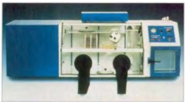
Figura 19. Dispositivo "Glove-box", empleado en el procesamiento e identificación de bacterias anaerobias.
